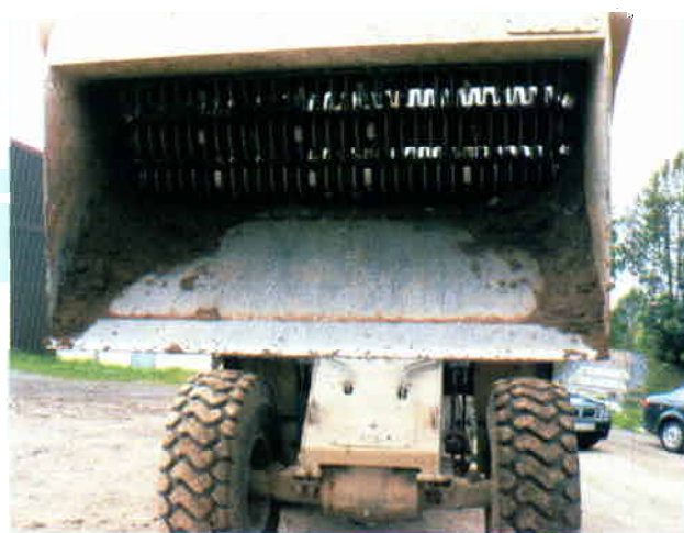
Rys. 2. Łyżka przesiewająco-krusząca z modułem dozującym
