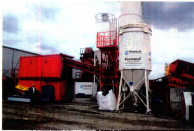
Bild 3: Stationäre Mischanlage Soilmix
