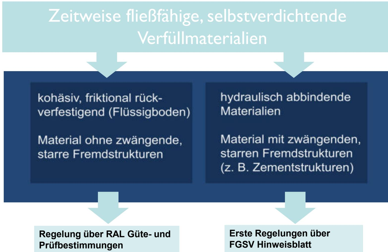
Systematik der zeitweise fließfähigen selbstverdichtenden Verfüllmaterialien
