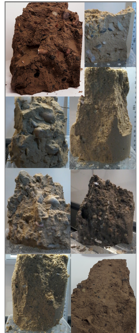
typische Strukturbruchbilder RSS Flüssigboden
