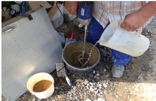
Erstellung einer „Eimer Mischung“ aus RSS Flüssigboden zur Bestimmung der Kubatur
