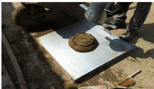
Bestimmung des Ausbreitmaßes zwecks Bestimmung der Kubatur
