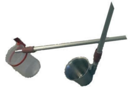
Sample collection device RSS Flüssigboden®
