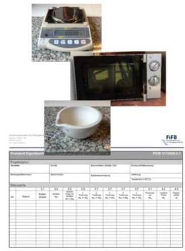
**Arbeitsmittel:** Mikrowelle mit 700 Watt, mikrowellengeeig-nete Schale, Waage (Genau-igkeit 1 Gramm), Protokoll Eigenfeuchte
