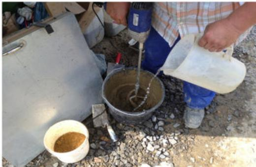
Erstellung einer „Eimermischung“ aus RSS Flüssigboden zur Bestimmung der Kubatur
