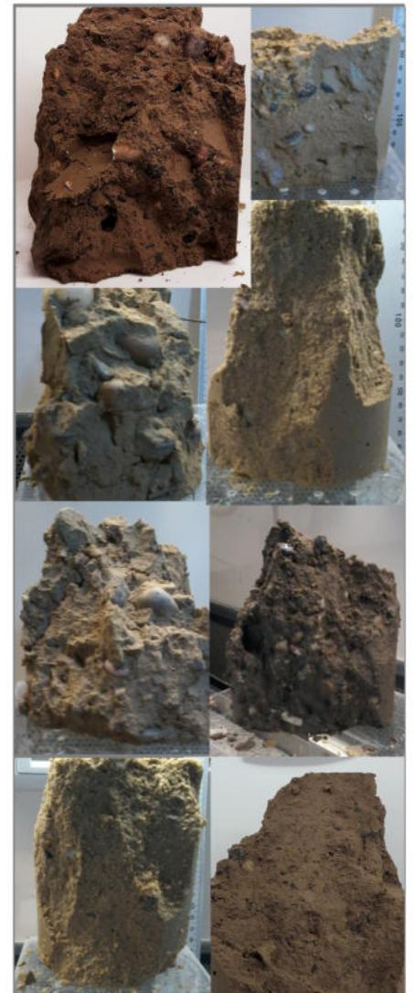
typische Strukturbruchbilder RSS Flüssigboden
