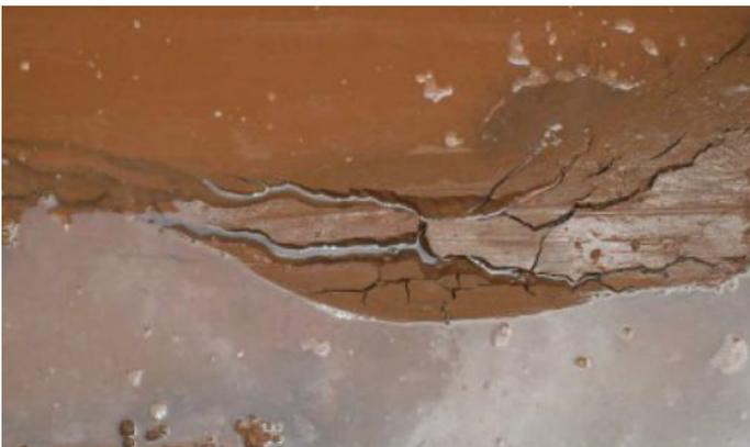
Hydraulischer Grundbruch in einem bindigen Boden;
