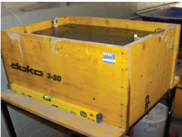
*Mit RSS Flüssigboden gefüllter Prüfbehälter [1]*
