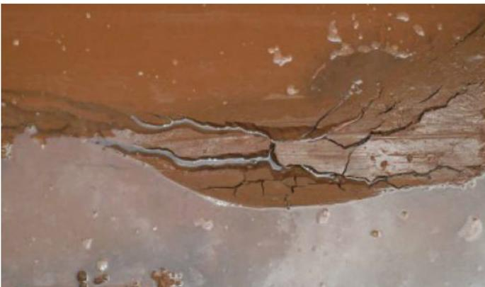
Hydraulischer Grundbruch in einem bindigen Boden;
