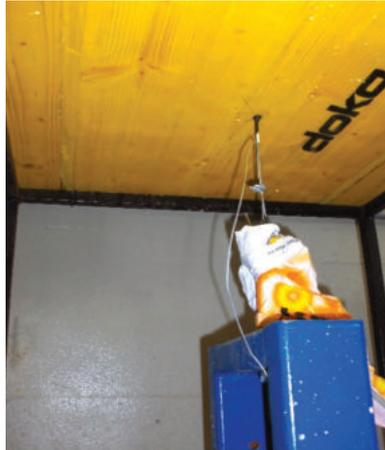
*Auftriebsmessung als Zugkraft [1]*
