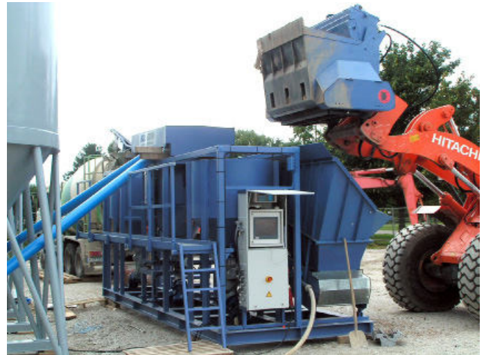
Neben der Technik zur Herstellung von Flüssigboden wurde auch die für die Steuerung notwendige Software entwickelt.
