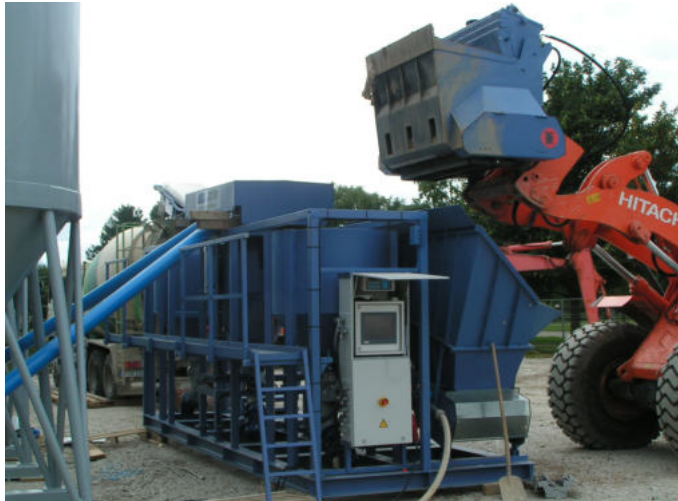
Dosiereinheit und Kompaktanlage in Funktion. Der Fachplaner muss genau wissen, wie die Bodengegebenheiten sind und das Flüssigbodengemisch eingestellt sein muss.
