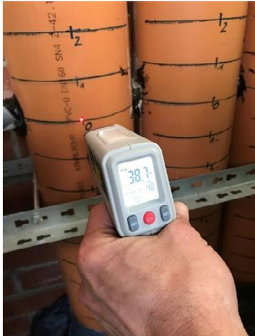
Abbildung 11: Messprinzip Oberflächentemperatur an den Kanalrohren
