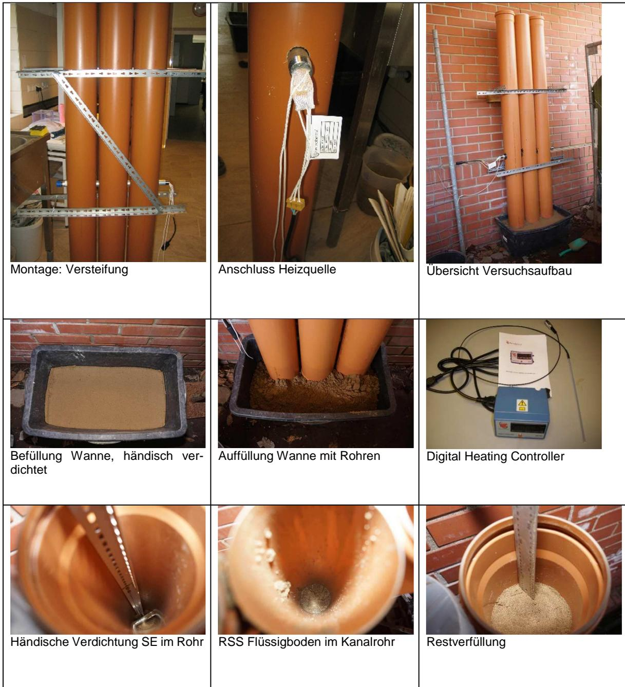
Abbildung 2: Fotoserie zum Versuchsaufbau
