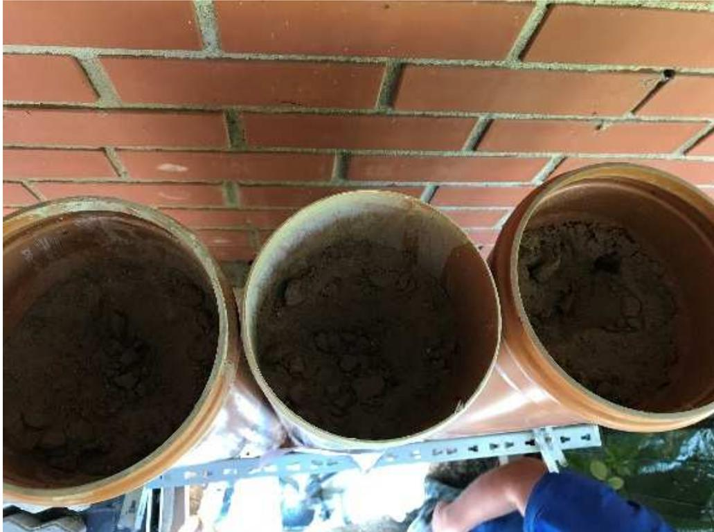
Abbildung 19: Versuchs-Draufsicht (Eigenfeuchtebestimmung Sandüberdeckung über Flüssigboden/Sand)
